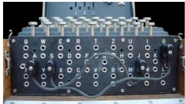
Figura 7 Il pannello a prese multiple della macchina Enigma; usando due cavetti sono scambiate le lettere S-O e A-J.
