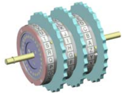
Figura 9 Struttura degli scambiatori della macchina Enigma.
