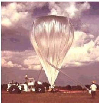
Per le misurazioni in quota (fatte cioè a una certa distanza dalla superficie terrestre) sono utilizzati i cosiddetti **palloni sonda**. Esistono anche speciali **aerei meteorologici**, che sono in grado di volare nel bel mezzo di uragani e tifoni.
